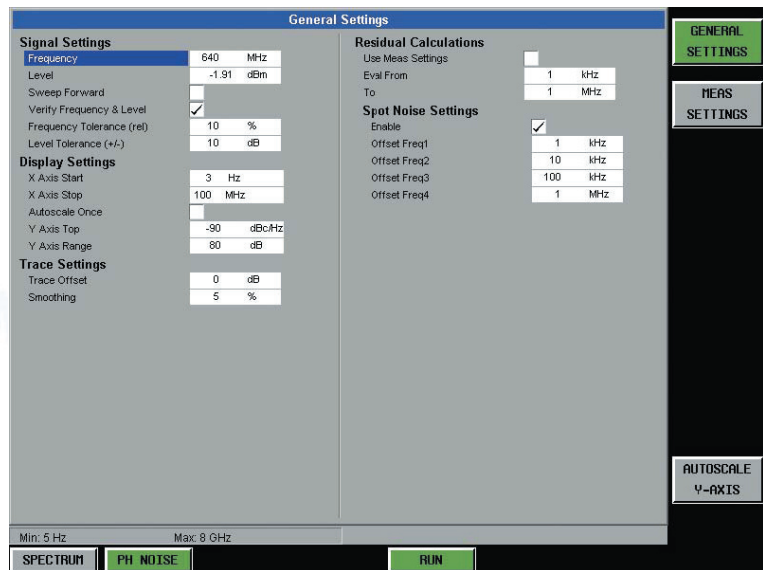
Рис.2: Установка глобальных параметров для измерений фазового шума:
